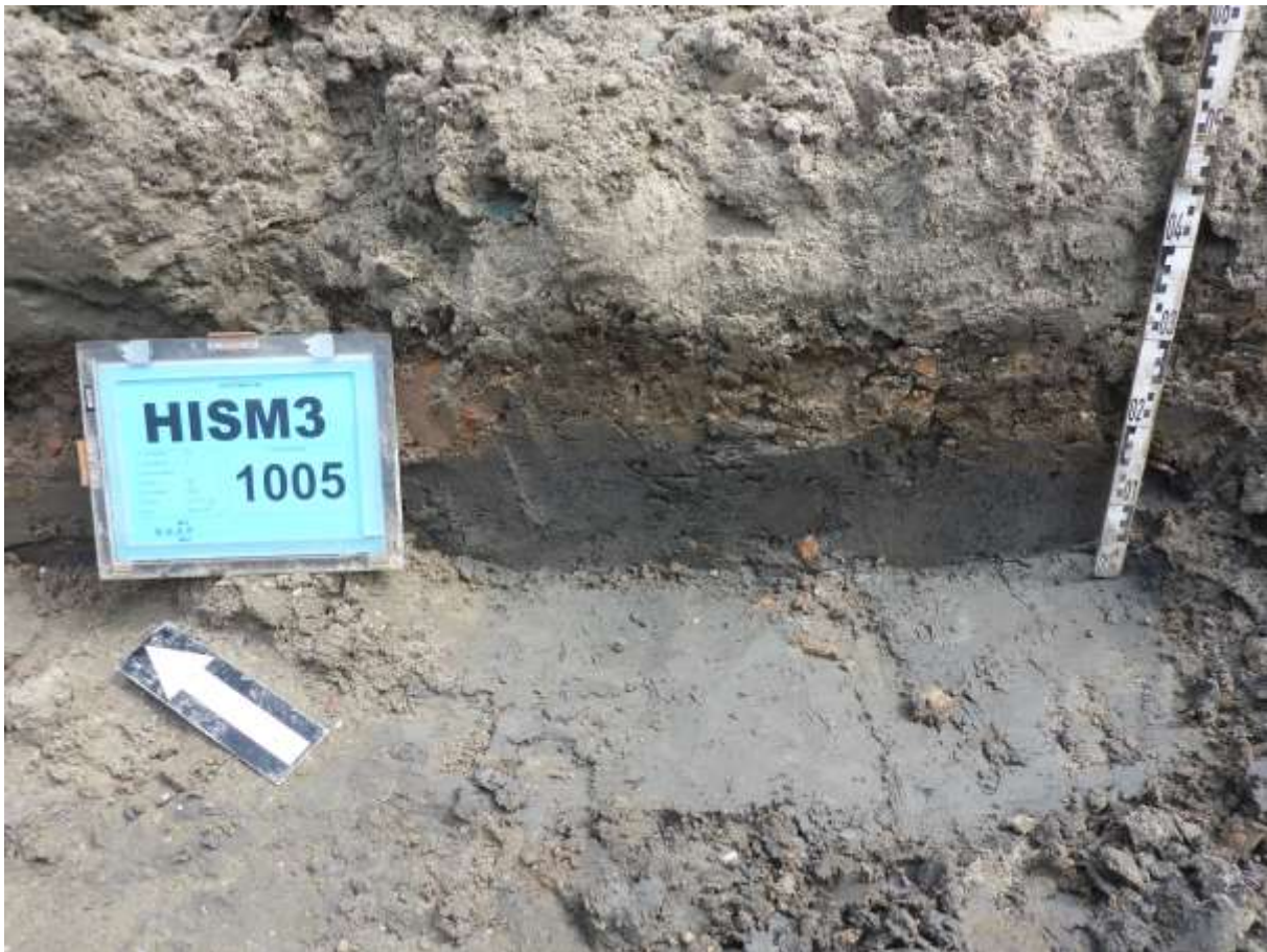
Figuur 6. De bodemopbouw in het grootste deel van het plangebied: recent zand op puinhoudende ophogingslagen en natuurlijke afzettingen.
